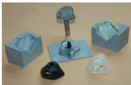
Фото 1. Комплект ФОД из материала LAB 1000 (серого цвета) и изготовленные в нем детали из ТПЭ
