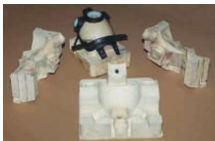
Фото 2. Комплект ФОД из материала ОВО 1000 (бежевого цвета) и изготовленные в нем детали из ТПЭ
